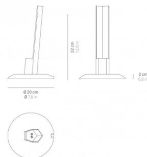
Base di ricarica a contatto che trasforma l'elemento luminoso Pencil in una lampada a batteria portatile e ricaricabile da terra o da tavolo. L'elemento luminoso può essere usato nel suo alloggiamento fisso, ma anche rimosso e portato con sé da un ambiente all'altro.
