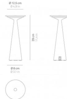
Dama pro è una lampada a batteria portatile e ricaricabile da tavolo. È dotata di: base di ricarica a contatto, touch dimmer e della funzione di selezione della temperatura di colore della luce tra 2700 e 3000° Kelvin (bianco dinamico). Versione con porta USB-a per la ricarica di dispositivi mobili.
