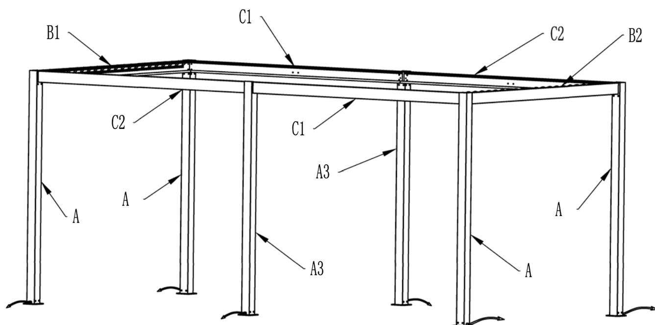
5. Le due estremita della trave anteriore e posteriore C1 devono essere inserite nei connettori angolari delle colonne A e A3; quindi serrarle con le viti K1.
