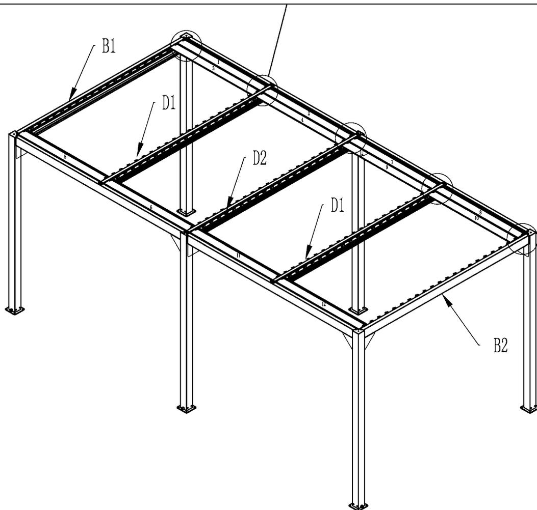
16. Inserire prima le rondelle piatte K3 nelle viti K2, fissarle nei fori sotto la trave D1/D2, quindi allineare le viti K2 con le rondelle piatte ai fori sulla parte superiore della trave C1/C2 e serrarle. Installare le altre pergole in successione.
